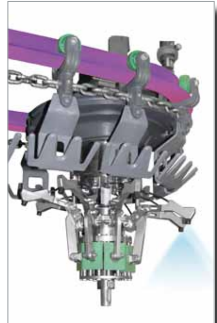
Führungsschiene (violett) für Schlachthaus-fördersystem
